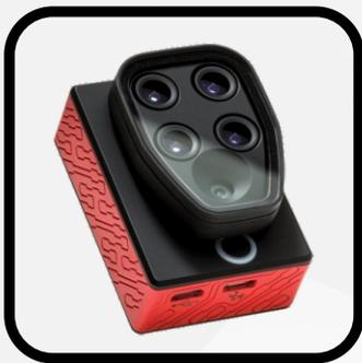
A Sequoia+, desenvolvida pela Parrot, é uma câmera multiespectral que possui 5 sensores, sendo 4 das bandas: Verde, Vermelho, Infra-Vermelho Próximo, Borda Vermelha (Red-Edge) e um sensor RGB para composição colorida.
